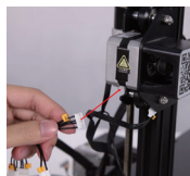
插入X轴电机线 Insert the X-axis motor cable
